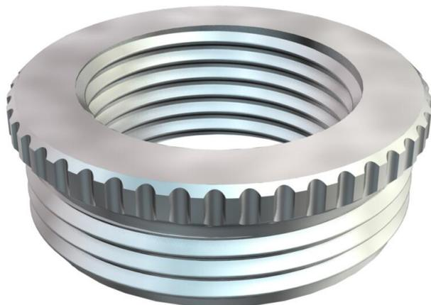
Reducción (parte H) según DIN 46320, con rosca PG según DIN 40430, para pasar de un orificio con rosca PG a un prensaestopas de pequeño tamaño.
