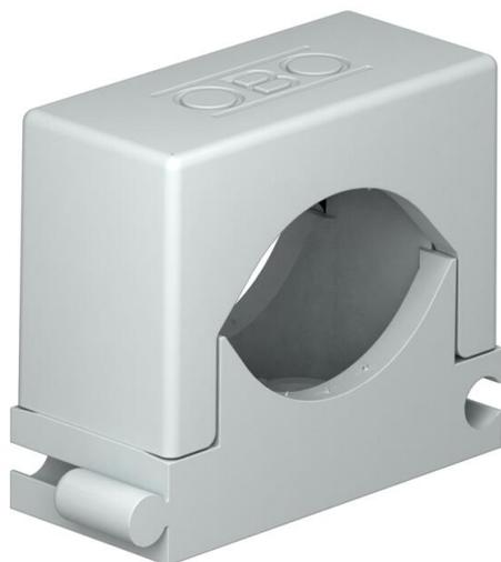
Abrazadera universal para la fijación individual de cables, conductores y tubos, todos los tamaños se pueden disponer en línea de manera aleatoria, con pata adhesiva, agujero alargado y para roscar en rosca M6.
