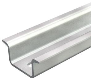
Carril DIN 35 x 15 mm según EN 60715 (antes DIN EN 50022), pero con un espesor de material de 1,5 mm.
