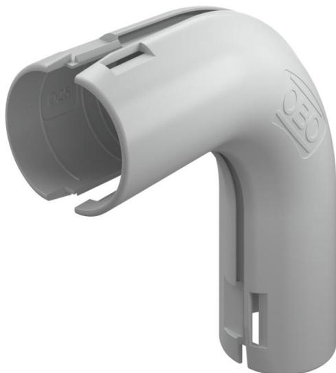
Pieza preformada para tubos de plástico para la instalación eléctrica para crear una curva de 90°. Apto para tubo Quick-Pipe o tubos corrugados. Cierre y apertura sin herramientas. Utilizable en el margen de temperatura de -25 °C a +60 °C.
