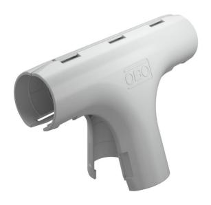
Pieza preformada para tubos de plástico para la instalación eléctrica para crear derivaciones en T. Apto para tubo Quick-Pipe o tubos corrugados. Cierre y apertura sin herramientas. Utilizable en el margen de temperatura de -25 °C a +60 °C.
