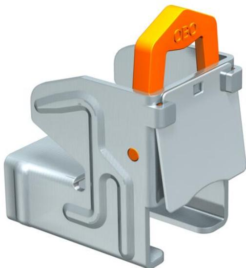
Abrazaderas de sujeción recubiertas con protección anticorrosión y sin tornillos, con muelle de bloqueo adecuado para perfiles tipo CML3518 y CMS3518. Para la fijación rápida en perfiles de acero en el montaje de bandejas de cables, abrazaderas semirredondas, suspensiones de luces, etc. Un sistema completo está compuesto de 2 abrazaderas de sujeción y una pieza de perfil en C de longitud opcional, y 2 tapones de protección.
