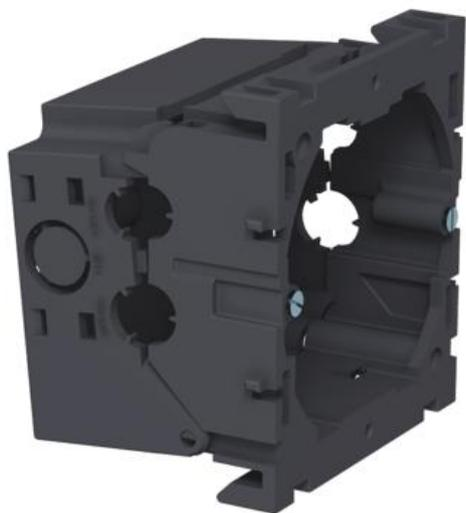
Cubeta para mecanismos estándar. La base se puede quitar o abatir, simplificando el proceso de conexión del cableado. Incluye perforaciones para cables de hasta 14 mm de diámetro. Modelo sin halógenos. Carril horizontal de fijación de 60 mm.
