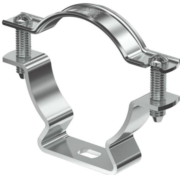
Abrazadera para el montaje de tubos y cables en la pared, el techo y el suelo. Con tapa autoblocante. Fijación a través de agujero alargado. A partir de tamaño de abrazadera 20 apropiado para el montaje con pistolas clavadoras y pistolas de pernos.
