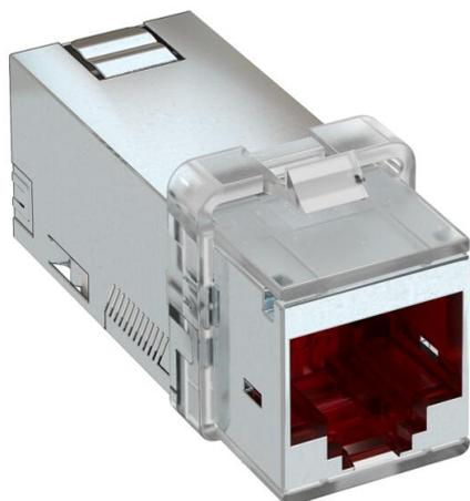
Módulo de conexión de cat. 6A (ISO) apantallado, para un conector RJ45. Incluye una cubierta de protección de compatibilidad electromagnética, una tapa antipolvo, una brida para cables, un marco de fijación Keystone y las instrucciones de montaje. Apropiado para el montaje en soportes para tecnología de datos de tipo DTG-2C y DTS-2C, en placas de soporte de tipo MTM 2C y MTM 3C, en placas de montaje tipo MPR2 2C y en soportes de montaje tipo MTGE2 2C, MTGE2 15 2C y MTGE2 F 2C.
