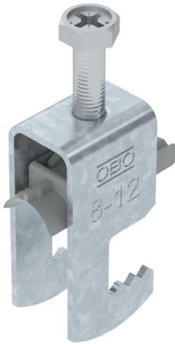
Abrazadera sobre perfil con base F, mediacaña de plástico de polipropileno. Para el montaje vertical y horizontal de 1 cable individual en perfiles planos. Con tornillo de 1 paso en la mediacaña, cabeza de tornillo hexagonal universal SW10, con ranura y ranura en cruz. Adecuado para montaje en zonas interiores y exteriores. Se recomienda el uso de una contra-caña.
