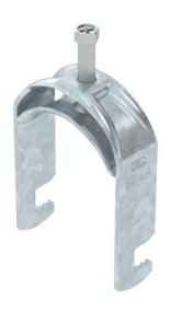
Abrazadera sobre perfil con base F, mediacaña metálica con bordes redondeados para proteger los cables. Para el montaje vertical y horizontal de 1 cable individual en perfiles planos. Con tornillo de 1 paso en la mediacaña, cabeza de tornillo hexagonal universal SW10, con ranura y ranura en cruz. Adecuado para montaje en zonas interiores y exteriores. Se recomienda el uso de una contracaña.
