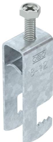
Abrazadera sobre perfil con base F, mediacaña metálica con bordes redondeados para proteger los cables. Para el montaje vertical y horizontal de 2 cables individuales en perfiles planos. Con tornillo de 1 paso en la mediacaña, cabeza de tornillo hexagonal universal SW10, con ranura y ranura en cruz. Adecuado para montaje en zonas interiores y exteriores. Es conveniente separar varios cables mediante cañas dobles. Se recomienda el uso de una contra-caña.
