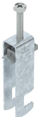
Abrazadera sobre perfil con base F, mediacaña de plástico de polipropileno. Para el montaje vertical y horizontal de 3 cables individuales en barras planas. Con tornillo de 1 paso en la mediacaña, cabeza de tornillo hexagonal universal SW10, con ranura y ranura en cruz. Adecuado para montaje en zonas interiores y exteriores. Es conveniente separar varios cables mediante cañas dobles. Se recomienda el uso de una contra-caña.
