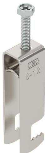
Abrazadera sobre perfil con base F, mediacaña metálica con bordes redondeados para proteger los cables. Para el montaje vertical y horizontal de 3 cables individuales en barras planas. Con tornillo de 1 paso en la mediacaña, cabeza de tornillo hexagonal universal SW10, con ranura y ranura en cruz. Adecuado para montaje en zonas interiores y exteriores. Es conveniente separar varios cables mediante cañas dobles. Se recomienda el uso de una contra-caña.
