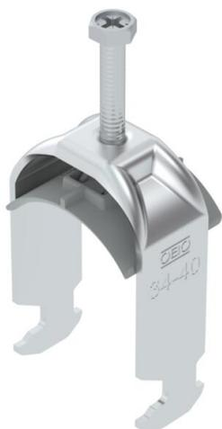
Abrazadera sobre perfil con base con cabeza de martillo, mediacaña de plástico de polipropileno. Para el montaje vertical y horizontal de 1 cable individual en perfil tipo C. Para ancho de ranura de 16 - 17 mm. Con tornillo de 1 paso en la mediacaña, cabeza de tornillo hexagonal universal SW10, con ranura y ranura en cruz. Adecuado para montaje en zonas interiores y exteriores. Se recomienda el uso de una contra-caña.
