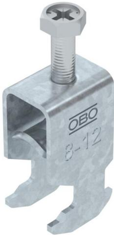
Abrazadera sobre perfil con base con cabeza de martillo, mediacaña metálica con bordes redondeados para proteger los cables. Para el montaje vertical y horizontal de 1 cable individual en perfil tipo C. Para ancho de ranura de 16 - 17 mm. Con tornillo de 1 paso en la mediacaña, cabeza de tornillo hexagonal universal SW10, con ranura y ranura en cruz. Adecuado para montaje en zonas interiores y exteriores. La contraña se debe pedir por separado.
