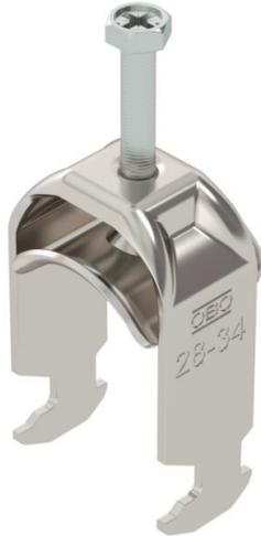
Abrazadera sobre perfil con base con cabeza de martillo, mediacaña metálica con bordes redondeados para proteger los cables. Para el montaje vertical y horizontal de 1 cable individual en perfil tipo C. Para ancho de ranura de 16 - 17 mm. Con tornillo de 1 paso en la mediacaña, cabeza de tornillo hexagonal universal SW10, con ranura y ranura en cruz. Adecuado para montaje en zonas interiores y exteriores. Se recomienda el uso de una contra-caña.
