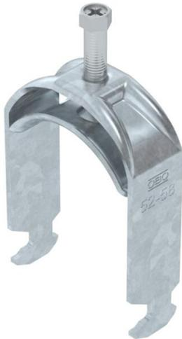
Abrazadera sobre perfil con base con cabeza de martillo, mediacaña metálica con bordes redondeados para proteger los cables. Para el montaje vertical y horizontal de 1 cable individual en perfil tipo C. Para ancho de ranura de 16 - 17 mm. Con tornillo de 1 paso en la mediacaña, cabeza de tornillo hexagonal universal SW10, con ranura y ranura en cruz. Adecuado para montaje en zonas interiores y exteriores. La contraña se debe pedir por separado.
