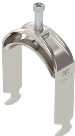
Abrazadera sobre perfil con base con cabeza de martillo, mediacaña metálica con bordes redondeados para proteger los cables. Para el montaje vertical y horizontal de 1 cable individual en perfil tipo C. Para ancho de ranura de 16 - 17 mm. Con tornillo de 1 paso en la mediacaña, cabeza de tornillo hexagonal universal SW10, con ranura y ranura en cruz. Adecuado para montaje en zonas interiores y exteriores. Se recomienda el uso de una contra-caña.
