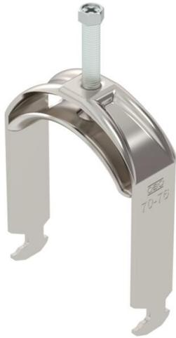
Abrazadera sobre perfil con base con cabeza de martillo, mediacaña metálica con bordes redondeados para proteger los cables. Para el montaje vertical y horizontal de 1 cable individual en perfil tipo C. Para ancho de ranura de 16 - 17 mm. Con tornillo de 1 paso en la mediacaña, cabeza de tornillo hexagonal universal SW10, con ranura y ranura en cruz. Adecuado para montaje en zonas interiores y exteriores. Se recomienda el uso de una contra-caña.
