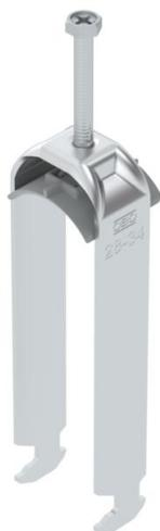
Abrazadera sobre perfil con base con cabeza de martillo, mediacaña de plástico de polipropileno. Para el montaje vertical y horizontal de 3 cables individuales en perfil tipo C. Para ancho de ranura de 16 - 17 mm. Con tornillo de 1 paso en la mediacaña, cabeza de tornillo hexagonal universal SW10, con ranura y ranura en cruz. Adecuado para montaje en zonas interiores y exteriores. Es conveniente separar varios cables mediante cañas dobles. Se recomienda el uso de una contra-caña.
