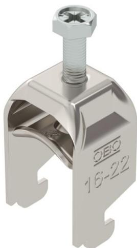
Abrazadera sobre perfil con base N, mediacaña metálica con bordes redondeados para proteger los cables. Para el montaje vertical y horizontal de 1 cable individual en perfil tipo C. Para ancho de ranura de 11 - 12 mm. Con tornillo de 1 paso en la mediacaña, cabeza de tornillo hexagonal universal SW10, con ranura y ranura en cruz. Adecuado para montaje en zonas interiores y exteriores. Se recomienda el uso de una contra-caña.
