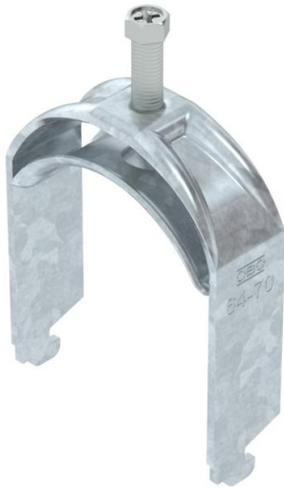
Abrazadera sobre perfil con base N, mediacaña metálica con bordes redondeados para proteger los cables. Para el montaje vertical y horizontal de 1 cable individual en perfil tipo C. Para ancho de ranura de 11 - 12 mm. Con tornillo de 1 paso en la mediacaña, cabeza de tornillo hexagonal universal SW10, con ranura y ranura en cruz. Adecuado para montaje en zonas interiores y exteriores. Se recomienda el uso de una contra-caña.
