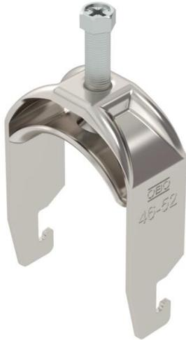
Abrazadera sobre perfil con base U, mediacaña metálica con bordes redondeados para proteger los cables. Para el montaje vertical y horizontal de 1 cable individual en perfil tipo C. Para ancho de ranura de 18 - 22 mm. Con tornillo de 1 paso en la mediacaña, cabeza de tornillo hexagonal universal SW10, con ranura y ranura en cruz. Adecuado para montaje en zonas interiores y exteriores. Se recomienda el uso de una contra-caña.
