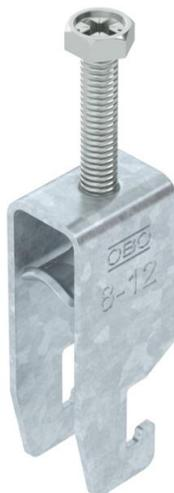
Abrazadera sobre perfil con base U, mediacaña metálica con bordes redondeados para proteger los cables. Para el montaje vertical y horizontal de 2 cables individuales en perfil tipo C. Para ancho de ranura de 18 - 22 mm. Con tornillo de 1 paso en la mediacaña, cabeza de tornillo hexagonal universal SW10, con ranura y ranura en cruz. Adecuado para montaje en zonas interiores y exteriores. Es conveniente separar varios cables mediante cañas dobles. Se recomienda el uso de una contra-caña.
