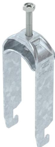
Abrazadera sobre perfil con base U, mediacaña metálica con bordes redondeados para proteger los cables. Para el montaje vertical y horizontal de 2 cables individuales en perfil tipo C. Para ancho de ranura de 18 - 22 mm. Con tornillo de 1 paso en la mediacaña, cabeza de tornillo hexagonal universal SW10, con ranura y ranura en cruz. Adecuado para montaje en zonas interiores y exteriores. Es conveniente separar varios cables mediante cañas dobles. Se recomienda el uso de una contra-caña.
