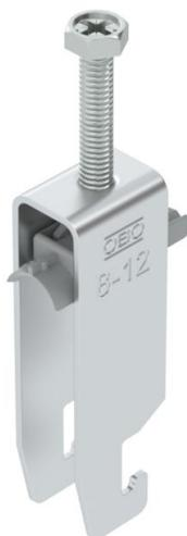
Abrazadera sobre perfil con base U, mediacaña de plástico de polipropileno. Para el montaje vertical y horizontal de 3 cables individuales en perfil tipo C. Para ancho de ranura de 18 - 22 mm. Con tornillo de 1 paso en la mediacaña, cabeza de tornillo hexagonal universal SW10, con ranura y ranura en cruz. Adecuado para montaje en zonas interiores y exteriores. Es conveniente separar varios cables mediante cañas dobles. Se recomienda el uso de una contra-caña.
