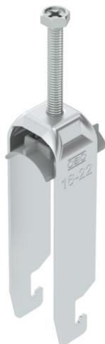
Abrazadera sobre perfil con base U, mediacaña de plástico de polipropileno. Para el montaje vertical y horizontal de 3 cables individuales en perfil tipo C. Para ancho de ranura de 18 - 22 mm. Con tornillo de 1 paso en la mediacaña, cabeza de tornillo hexagonal universal SW10, con ranura y ranura en cruz. Adecuado para montaje en zonas interiores y exteriores. Es conveniente separar varios cables mediante cañas dobles. Se recomienda el uso de una contra-caña.
