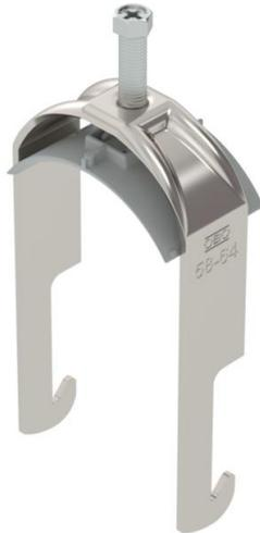
Abrazadera sobre perfil con base W, mediacaña de plástico de polipropileno. Para el montaje vertical y horizontal de 1 cable individual en perfiles angulares hasta < 40 mm. Con tornillo de 1 paso en la mediacaña, cabeza de tornillo hexagonal universal SW10, con ranura y ranura en cruz. Adecuado para montaje en zonas interiores y exteriores. Se recomienda el uso de una contra-caña.
