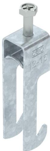
Abrazadera sobre perfil con base W, mediacaña metálica con bordes redondeados para proteger los cables. Para el montaje vertical y horizontal de 1 cable individual en perfiles angulares hasta < 40 mm. Con tornillo de 1 paso en la mediacaña, cabeza de tornillo hexagonal universal SW10, con ranura y ranura en cruz. Adecuado para montaje en zonas interiores y exteriores. Se recomienda el uso de una contra-caña.
