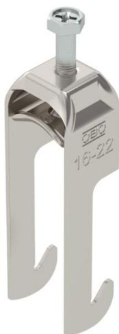
Abrazadera sobre perfil con base W, mediacaña metálica con bordes redondeados para proteger los cables. Para el montaje vertical y horizontal de 1 cable individual en perfiles angulares hasta < 40 mm. Con tornillo de 1 paso en la mediacaña, cabeza de tornillo hexagonal universal SW10, con ranura y ranura en cruz. Adecuado para montaje en zonas interiores y exteriores. Se recomienda el uso de una contra-caña.
