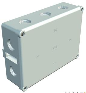
Grado de protección IP54, tensión nominal 660 V, sección nominal 16 -  $mm^2$ , 2 orificios de fijación de hasta 6 mm de  $\varnothing$  en el exterior de la caja. 4 Tomillos de tapa, 10 Entradas rompibles con rosca M25 x 1,5.
