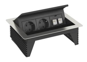
Deskbox abatible con cable de conexión, para el montaje fijo en un tablero de mesa, caja de acero inoxidable cepillado con regleta con escobilla para la salida de cables. Se monta en un orificio de montaje de 235 x 157 mm en el tablero de la mesa.
