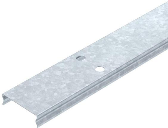
Tapa con enclavamiento para bandejas de rejilla GR y GRM. Protege cables y conductos de daños, suciedad, humedad desde arriba. Adecuado para áreas industriales como construcción de máquinas e instalaciones. Con acanaladuras transversales a partir de 400 mm de anchura. Si se utilizan tapas en el exterior, en determinadas circunstancias hay que tomar medidas adicionales contra los efectos del viento.
