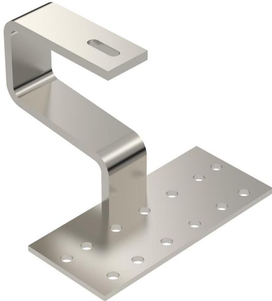
Gancho de tejado pesado para montaje de módulos fotovoltaicos en tejados inclinados en combinación con el perfil de soporte TP 45. Apto para tejados de tejas. Fijación al perfil de soporte con tornillo con tuerca de martillo tipo SKSHM A2. Montaje en vigas con tornillos de cabeza plana TKS.
