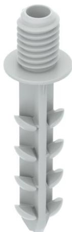
Taco de expansión Delta-Push® para el montaje en la instalación eléctrica. Adecuado para hormigón, ladrillo de cal y arena, ladrillo macizo, ladrillo perforado y hormigón celular. Montaje a presión sin herramientas en pared o techo. Sin tornillos. Con rosca M6 para atornillar, p. ej., abrazaderas Quick.
