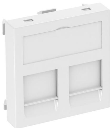
Soporte de datos con salida recta y persianas antipolvo para alojar dos módulos de conexión de datos con toma RJ45. Se puede instalar tanto vertical como horizontalmente. El tipo C tiene una abertura de montaje de 19,30 x 14,80 mm y está diseñado para la fijación directa de los módulos de conexión de datos en la abertura de montaje.
