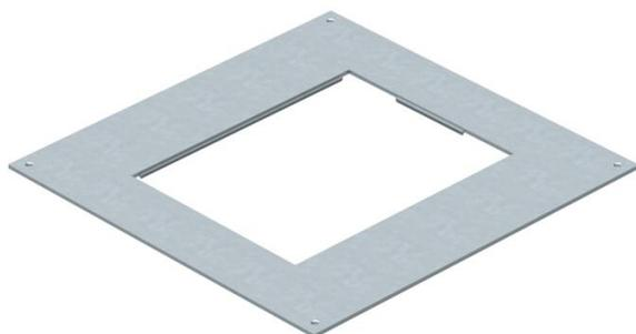
Tapa adaptadora para cajas de derivación y registro bajo suelo del tipo UZD250-3/4 para montar una unidad de instalación de tamaño nominal R6. Abertura de montaje a 3 mm de profundidad para poder cerrarla posteriormente con una tapa ciega.
