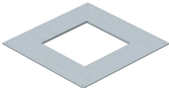
Tapa adaptadora para cajas de derivación y de registro del tipo UZD350-3 y UZD350-4 para montar una unidad de montaje. Abertura de montaje a 3 mm de profundidad para poder cerrarla posteriormente con una tapa ciega.
