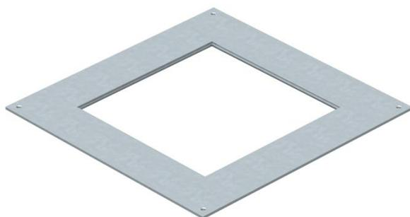
Tapa adaptadora para cajas de derivación y registro bajo suelo del tipo UZD350-3/4 para montar una unidad de instalación de tamaño nominal R9. Abertura de montaje a 3 mm de profundidad para poder cerrarla posteriormente con una tapa ciega.
