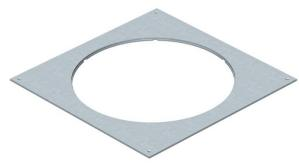
Tapa adaptadora para cajas de derivación y registro bajo suelo del tipo UZD350-3/4 para montar una unidad de montaje de tamaño nominal R9. Abertura de montaje a 3 mm de profundidad para poder cerrarla posteriormente con una tapa ciega.
