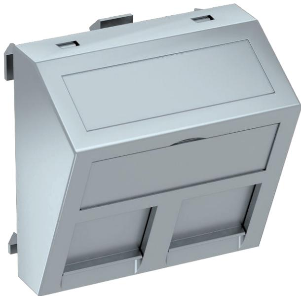
Soporte de datos con salida transversal y deslizante de cierre para alojar dos módulos de conexión de datos con toma RJ45. Se puede instalar tanto vertical como horizontalmente. El tipo B tiene una abertura de montaje de 19,35/21,55 x 14,85 mm y está diseñado para la fijación directa de los módulos de conexión de datos en la abertura de montaje.
