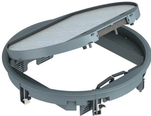
Conjunto portamecanismos con capacidad para un máximo de 12 mecanismos individuales Modul 45 en 3 soportes universales UT4, montaje en sistemas de canalización y suelos modulares. Entalladura para revestimiento de suelo en la tapa abatible de 5 mm.
