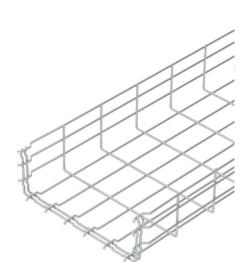
Bandeja de rejilla con conexión rápida de ala 105 mm. Para la bandeja de rejilla no se necesitan componentes adicionales, simplemente se engancha la una con la otra. El ancho de malla es de 50 x 100 mm.
