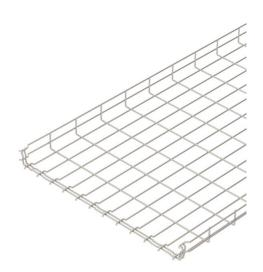
Bandeja de rejilla con conexión de unión rápida de ala 55 mm. Para la bandeja de rejilla no se necesitan componentes adicionales, simplemente se engancha la una con la otra. El ancho de malla es de 50 x 100 mm (excepción GRM  $55/50 = 20 \times 100$  mm). Aislamiento magnético sin tapa 15 dB, con tapa 25 dB.
