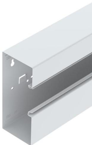
Canal portamecanismos GS para el montaje directo en la pared o en consolas de fijación. El canal portamecanismos GS dispone de unas pestañas en su base para colocar el tabique separador. La conexión equipotencial entre las bases de dos tramos de canal está garantizada gracias a las uniones. La conexión equipotencial entre la tapa y el cuerpo está asegurada al colocar la tapa. La abertura del sistema mide realmente 76,5 mm. La tapa se debe pedir por separado.
