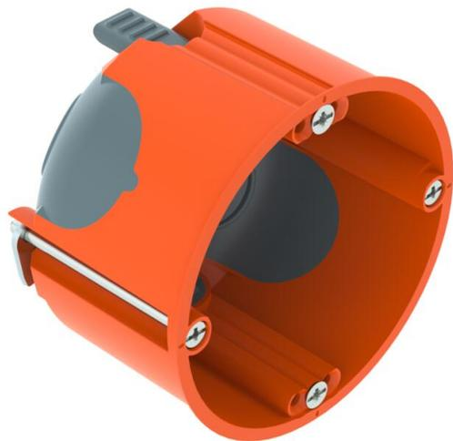
Caja portamecanismos para paredes huecas con entradas de membrana herméticas, para el uso en paredes huecas con una profundidad de montaje de mínimo 47 mm y un grosor de placa de 5 - 40 mm. • 2 x 3 domos roscados
