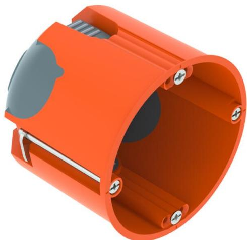
Caja portamecanismos para paredes huecas con entradas de membrana herméticas, para el uso en paredes huecas con una profundidad de montaje de mínimo 61 mm y un grosor de placa de 5 - 40 mm. • 2 x 3 domos roscados
