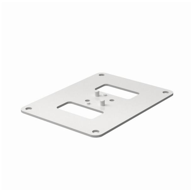
Placa base con borde visible de 30 mm y 4 agujeros de fijación de Ø 8,5 mm. La placa base es adecuada para el montaje de columnas de distribución del tipo ISS70110.
