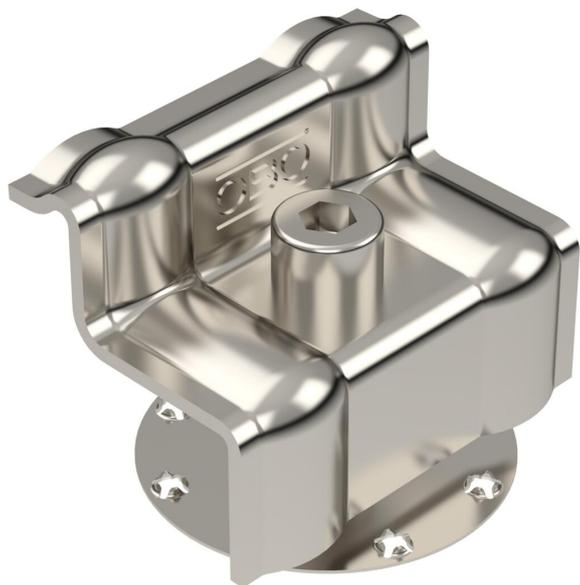
Abrazadera final con muelle para la fijación de módulos fotovoltaicos en perfiles de soporte. Apto para ancho de ranura de 10 mm. Fijación atornillable del módulo fotovoltaico con llave Allen tamaño 6.
